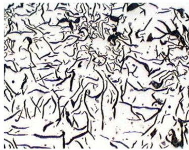
Figura 2.3 Metalografía de las fundiciones. Hojuelas de grafito en el hierro fundido gris.
