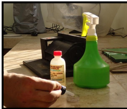
Figura 6.21 Ataque químico sobre la probeta de hierro con Nital 2.
