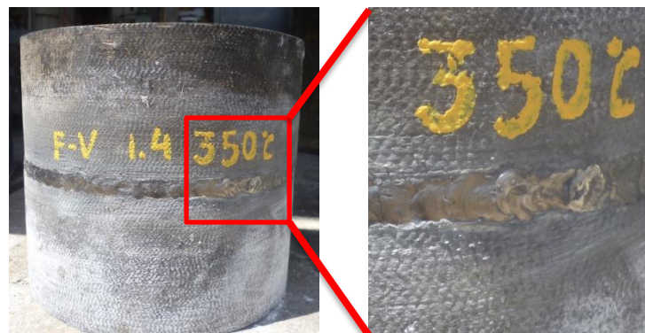
Figura 6.34 Ensayo visual de la junta soldada después de su enfriamiento.
