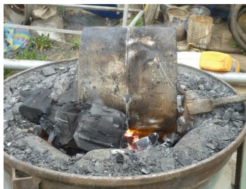
Figura 6.28 Precalentamiento de las muestras en la fragua.
