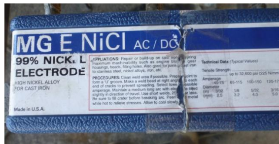
Figura 6.27 Electrodo para soldar hierro fundido, designación: nickel 99 (AWS A5.15 Ni-Ci).
