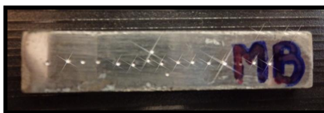
Figura 6.14 Probeta de dureza ensayada en 10 puntos.
