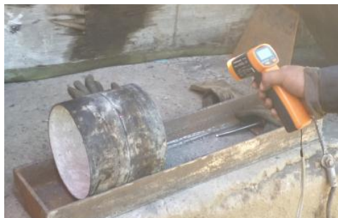
Figura 6.31 Control de la temperatura de precalentamiento.
