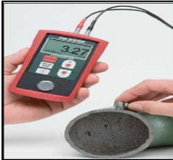
Figura 2.4 END Medición de espesor en tuberías Fuente: Rimoldi & Mundo,ENDU, p.01
