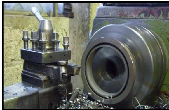
Figura 6.5 Rectificado del asiento Fuente: Egdo. Eduardo Sánchez
