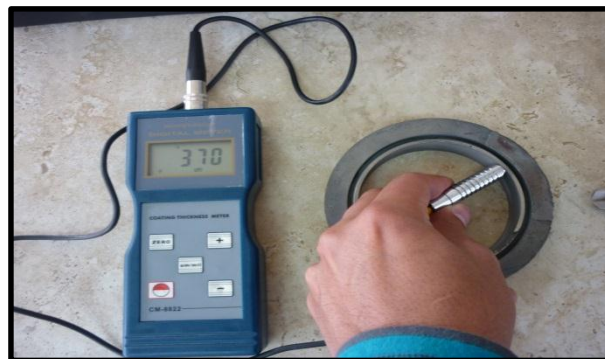
Figura 6.7 Medición de espesores
