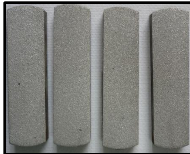
Figura 6.9 Probetas rectificadas para ensayo de desgaste Fuente: Egdo. Eduardo Sánchez
