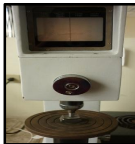
Figura 6.18 Calibración del durómetro
