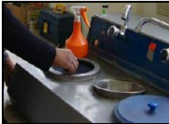
Figura 6.23 Pulido de la muestra Fuente: Egdo. Eduardo Sánchez
