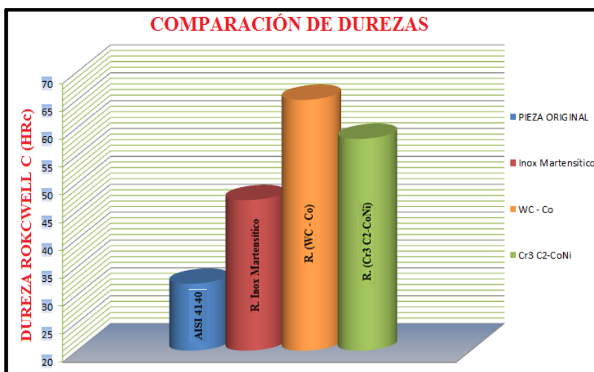
Figura 4.9 Comparación de dureza en pieza original vs recubrimientos adheridos por proyección HVOF
