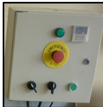
Figura 6.14 Caja de control Fuente: Egdo. Eduardo Sánchez
