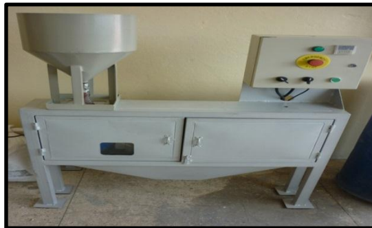
Figura 6.11 Máquina de ensayo de desgaste abrasivo Fuente: Egdo. Eduardo Sánchez
