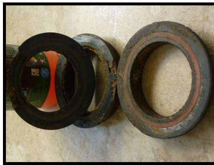
Figura 6.1 Obtención de asientos de válvula API-600
