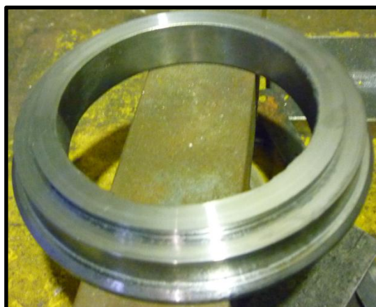
Figura 6.6 Asiento terminado Fuente: Egdo. Eduardo Sánchez
