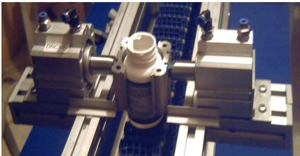
**Figura 63:** Sistema de retención
