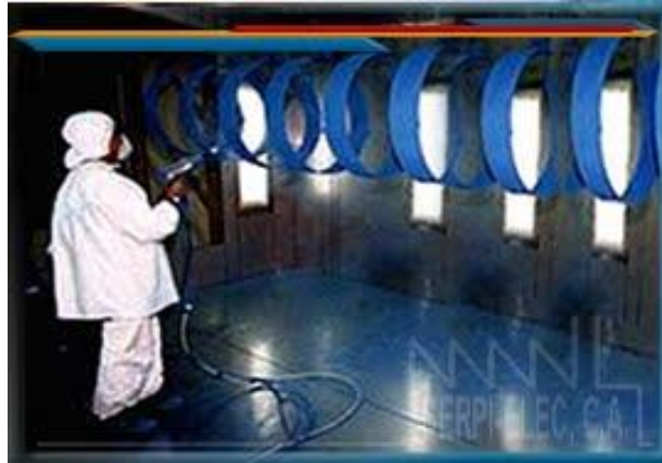
Figura 2-19: Cabinas de aplicación Fuente: www.europintura.com
