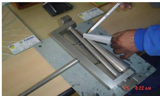
Figura 4-11: Ejecución del ensayo de flexibilidad Fuente: Valencia Alvaro.
