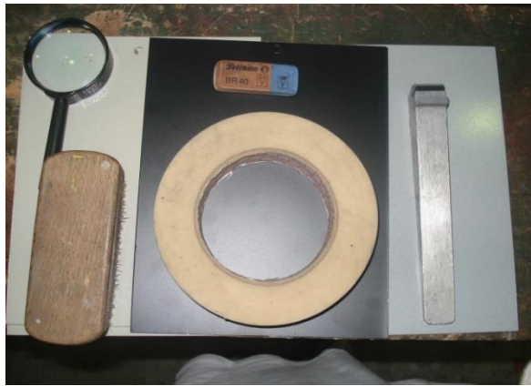
Figura 4-13: Implementos para el ensayo de adherencia Fuente: Valencia Alvaro.
