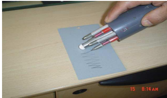
Figura 4-9: Ejecución del ensayo de dureza Fuente: Valencia Alvaro.
