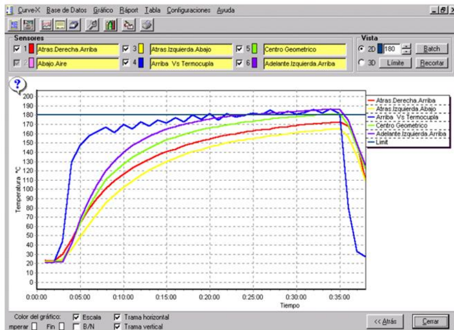
Figura 4-5: Curvas de curado de la pintura epoxi poliéster, horno eléctrico bache. Fuente: Valencia Alvaro.
